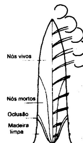
Figura 2-6 – As quatro regiões dentro do tronco de uma árvore, em função da característica dos nós.
